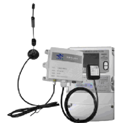
图 2.3 采集设备安装
