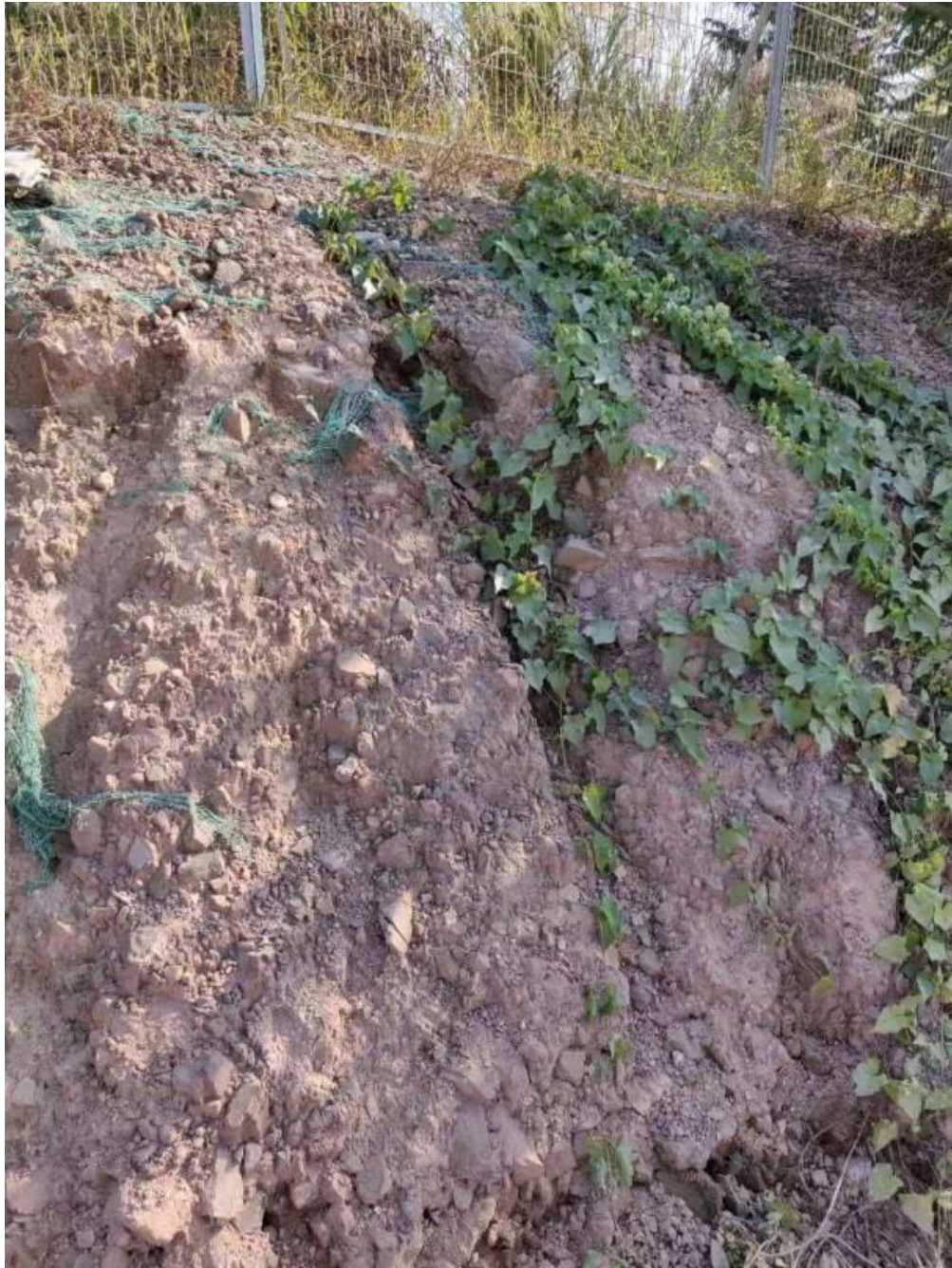
图 6.3-4 紫红色含大量岩块的残坡积层（一期项目场地东侧边缘）
